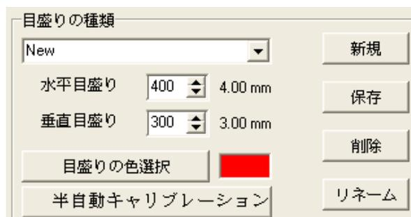
図 5-50 水平（X軸）目盛りと垂直（Y軸）目盛りの数値を入力
