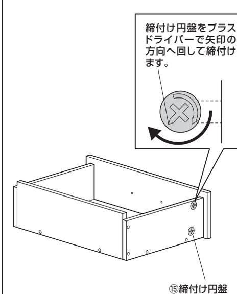
36. 締付け円盤を取付けます。
