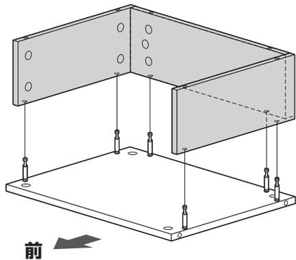
10. 背板と側板に締付け円盤を取付けます。
