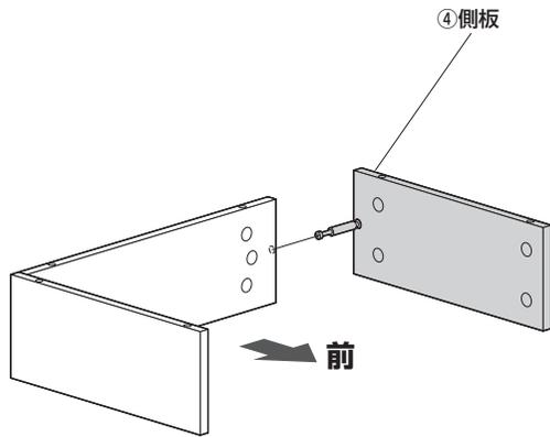
6. 背板に締付け円盤を取付けます。
