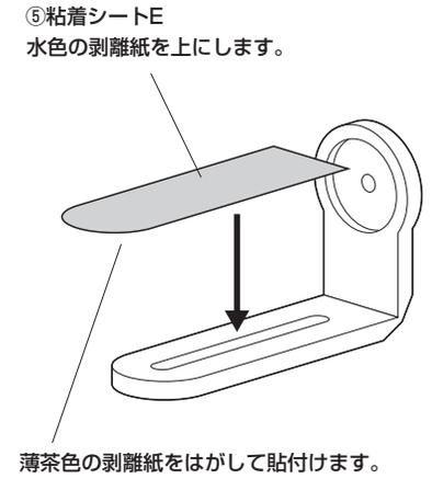
3.アームにホルダーを取付けます。 ※スピーカー背面の取付け穴で、アームBにスピーカーを直接取付ける場合は不要です。
