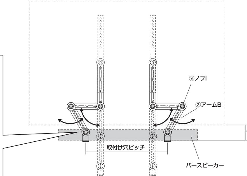
※スピーカーをホルダーにボルトで固定しない場合も同様にアームを調節します。
