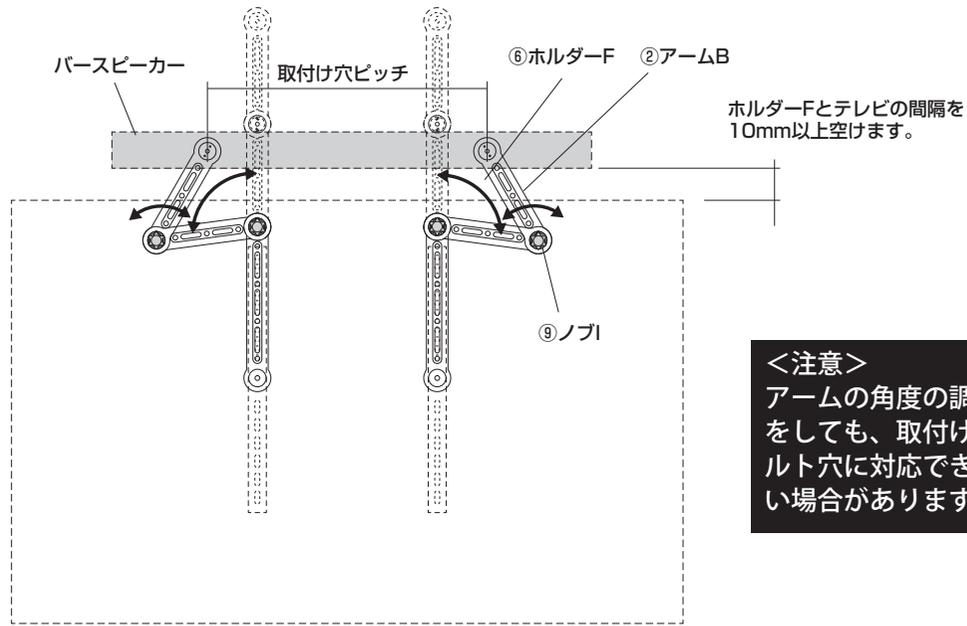
6.アームにスピーカーを取付けます。(ボルトで直接取付ける場合)
