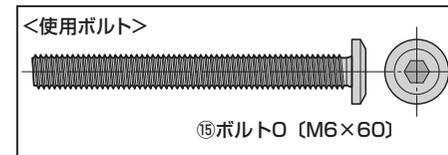
※ボルトO 2本を締めた後に、フレーム(上)(下)(左)(右)をゆるく留めていたボルトQ 8本も最後まで締めます。
