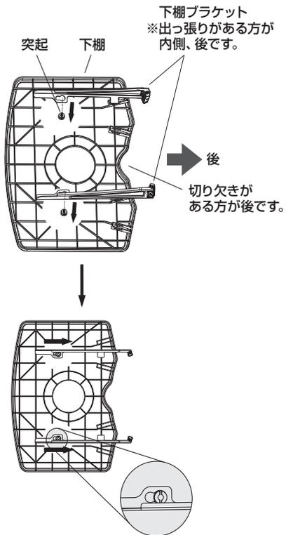
② フレームA側面の溝に下棚ブラケットのツメを押し込み、ボルトを締め固定します。
