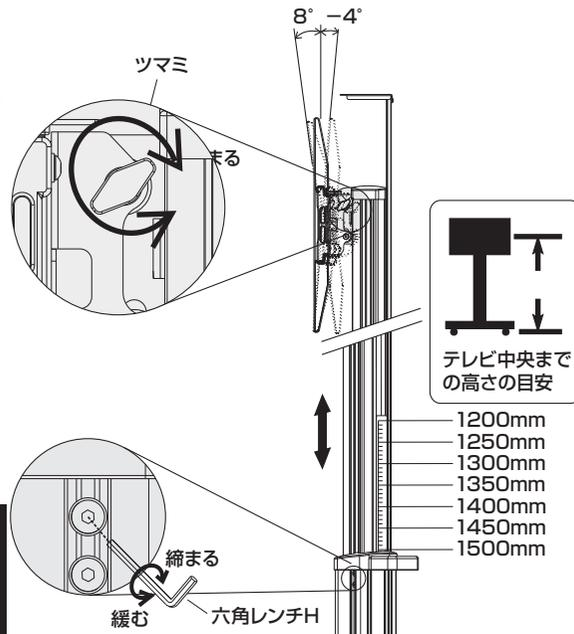
テレビをブラケットBごと取外し、フレームA側面のボルトを回して緩めるとフレームAの高さ調節ができます。調節後はしっかりと締付けて固定してください。
