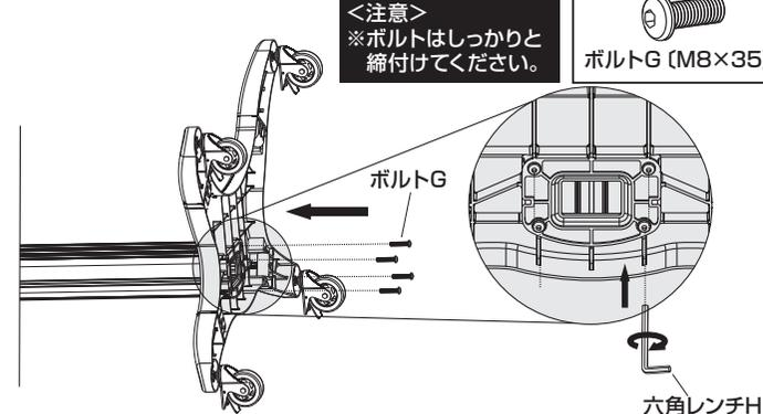
3. フレームA側面の下側の穴にボルトを付けます。
