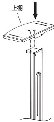
③ 取外していたボルト、皿ボルトで固定します。
