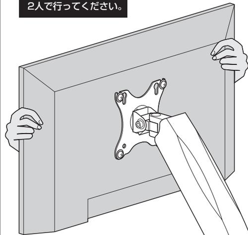
④固定しているボルトを取外します。
