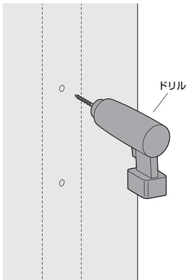
②タッピングボルトでベース部を固定します。
