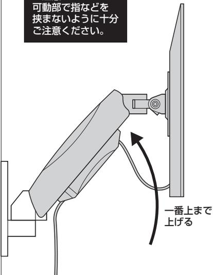
②組立手順6.に従ってケーブルホルダーを取外し、テレビからケーブルを抜き取ります。
