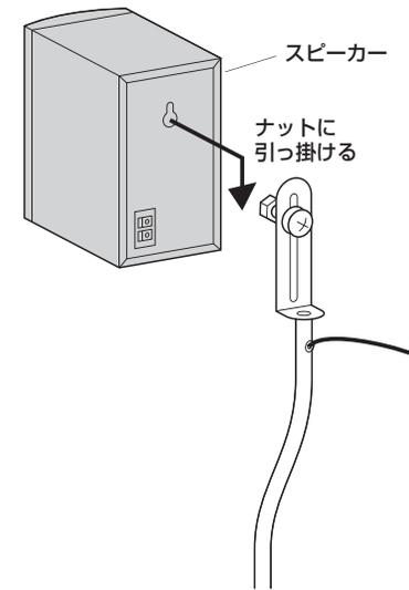
④ボルトを締め付けて固定します。
