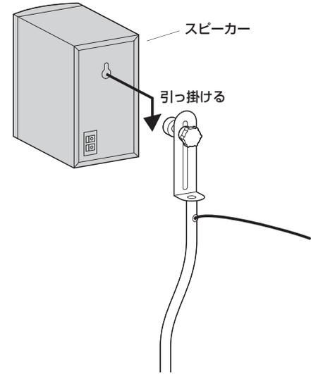
④化粧ナットを締め付けて固定します。
