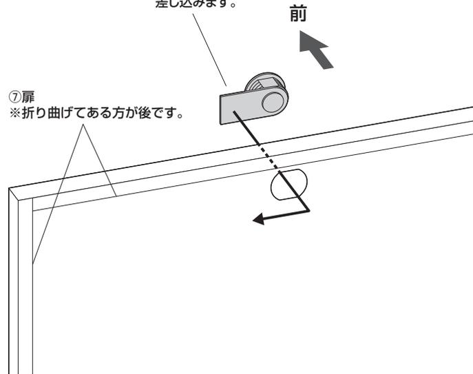
② ナットを取付けて固定します。
