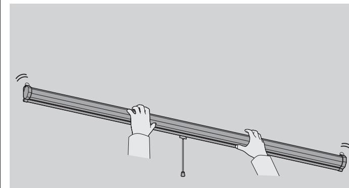
**注意** 揺らした時に製品が動く場合は、固定が不十分です。製品が動かなくなるように固定し直してください。
