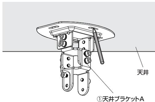
②ドリルを使い壁に印をつけた**4ヶ所**に直径10mm、深さ約60mmの下穴をあけます。
