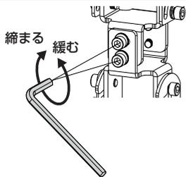
天井ブラケットAの角度を調節することができます。調整後はしっかりと締め付けてください。
