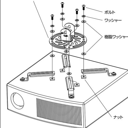
※最後に全てのボルトを締付けて、固定します。
