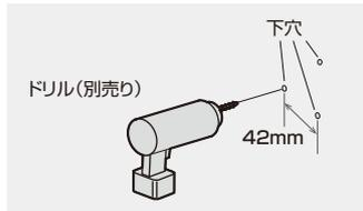
③付属のタッピングネジで、センサーライトを壁に取付けます。
