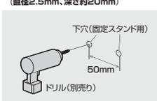
②付属のタッピングネジで、固定スタンドを壁に取付けます。
