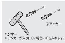
③付属のタッピングネジをアンカーに差込み、固定スタンドを壁に取付けます。
