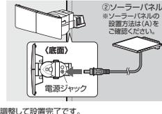
⑨ センサーライトのLED、ソーラーパネルの角度を調整して設置完了です。
