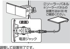
⑩ センサーライトのLED、ソーラーパネルの角度を調整して設置完了です。
