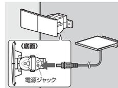
⑧ センサーライトのLED、ソーラーパネルの角度を調整して設置完了です。
