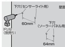
④ 付属のタッピングネジで、アタッチメントAとソーラーパネルを壁に固定します。
