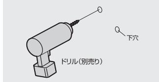
②付属の固定用ネジ(大)で、センサーライトを壁に取付けます。
