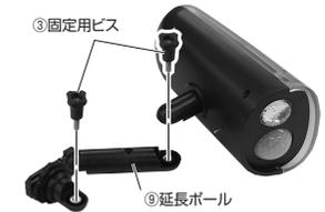
延長ポールは任意の向きに組み替えてから固定用ネジ(小)で固定します。
