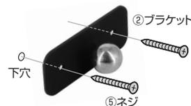
！ 石膏ボード部へ取付ける場合は必ず壁の内部に芯材がある場所に設置してください。
