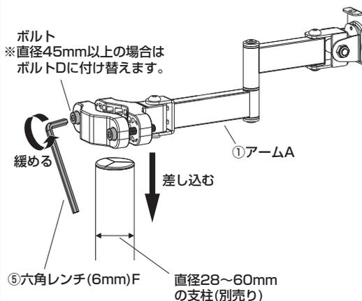
②ボルトを締め付けて固定し、ケーブルフックEを取付けます。
