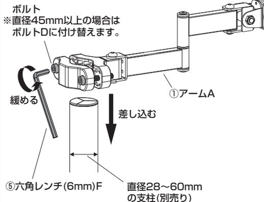
②ボルトを締め付けて固定し、ケーブルフックEを取付けます。
