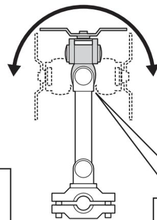
キャップをはずし、スパナでナットを締め付けて調節します。
