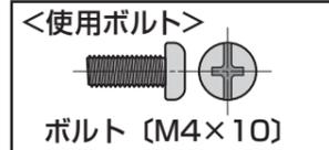
※ボルトが最後まで締まらない、またボルトが少ししか回っていないなど、ボルトが合わない場合は、強度に十分ご注意ください。市販の適切なボルトをご用意ください。
