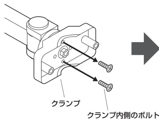
② クランプを90°回転させてボルトで固定します。
