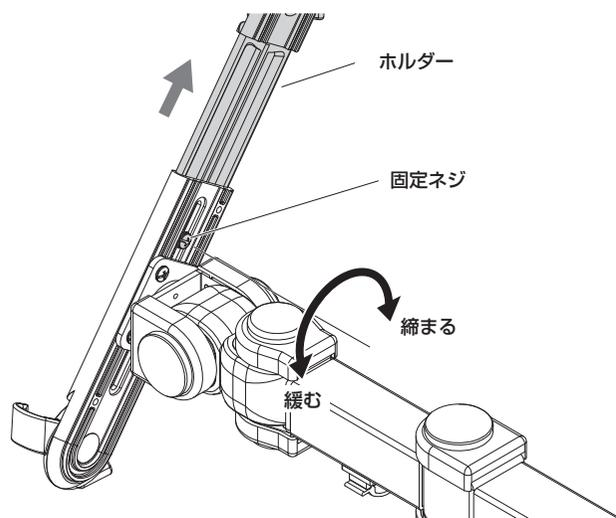
※ホルダーを縮めてタブレットを挟み込みます。固定ネジを締めます。
