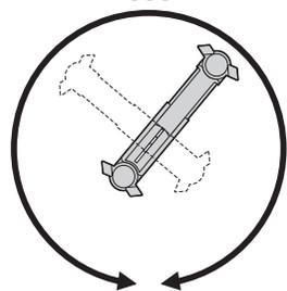
キャップをはずし、スパナでナットを締め付けて調節します。
