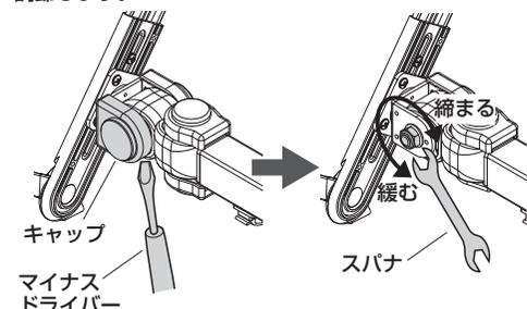
キャップをはずし、スパナでナットを締め付けて調節します。
