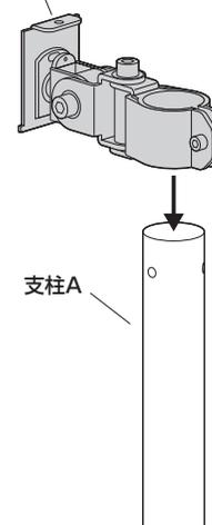
③任意の高さでアームFのボルトを締め付けて固定します。
