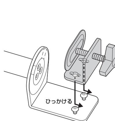
④クランプDのボルトを締め付けて固定します。
