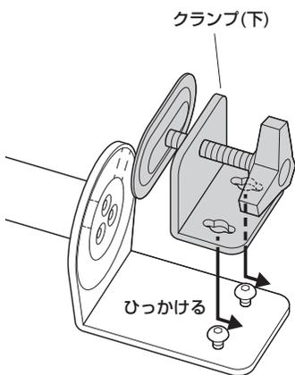
②クランプDのボルトを締め付けて固定します。
