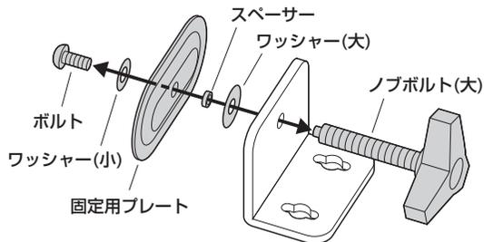
②クランプ(下)の向きを変え、下図の通り組み合わせます。
