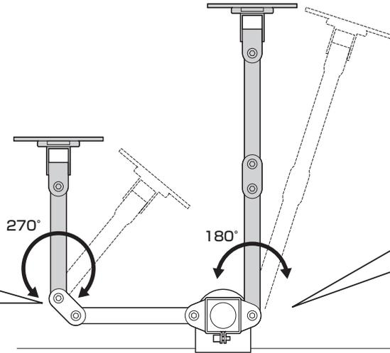
アームの動きが軽すぎたり、重すぎる場合はドライバー付き六角レンチ(5mm)でボルトを回して調節します。
