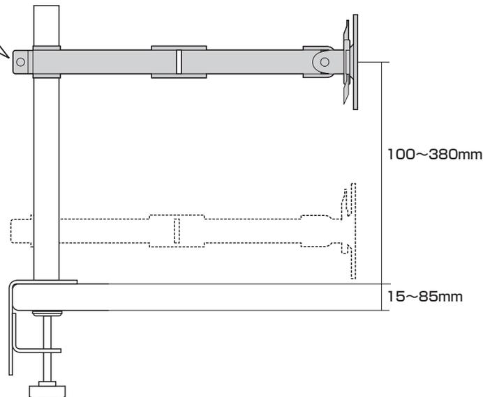
アームの動きが軽すぎたり、重すぎる場合は六角レンチ(6mm)でボルトを回して調節します。
