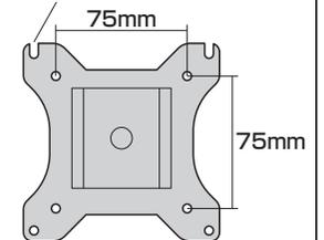
※ネジ穴ピッチ 75mm×75mmの場合 内側の穴を使います。
