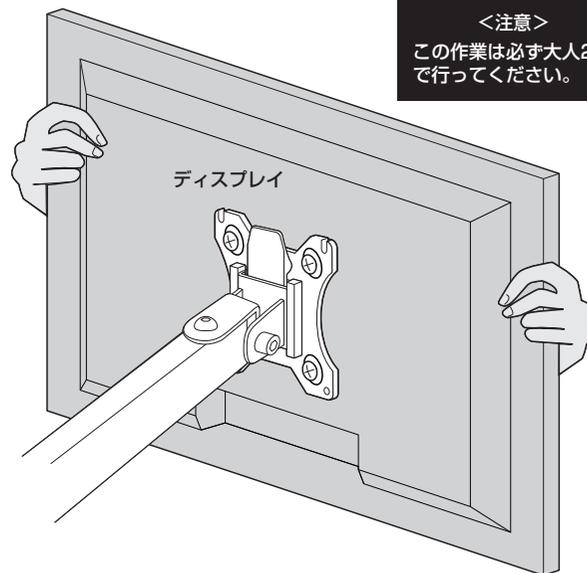
②固定しているボルトを取外します。
