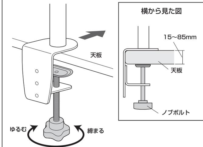
※ノブボルトを締めて固定します。
