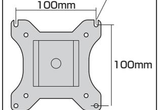
※ネジ穴ピッチ 100mm×100mmの場合 外側の穴を使います。
