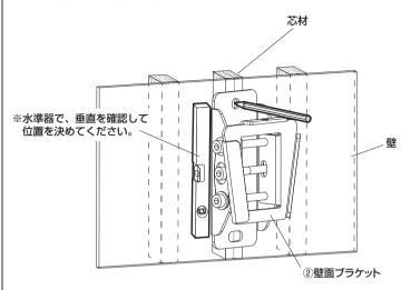
②ドリルを使い壁に印をつけた2ヶ所に直径4.5mm 深さ約55mmの下穴をあけます。
