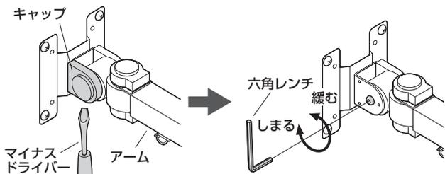
六角レンチでボルトを締め付けて調節します。
