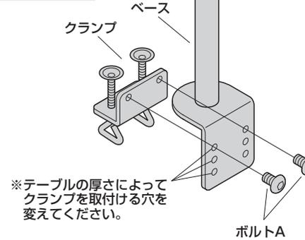
② クランプで締め込み、テーブルに固定します。
