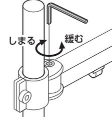
つまみを回して緩めると、アームの高さを調節することができます。高さを調節した後は、つまみを回してしっかりと固定します。
