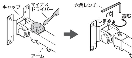
キャップをはずし、六角レンチでボルトを締め付けて調節します。
