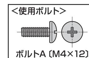
※付属のボルトが最後まで締まらない、またボルトが少ししか回っていないなど、ボルトが合わない場合は、強度に十分ご注意の上、市販の適切なサイズのボルトをご用意ください。
