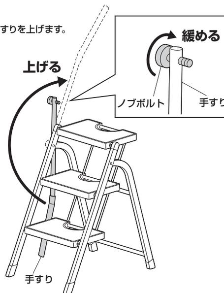
③ネジ穴にノブボルトを差し込み、締付けます。
