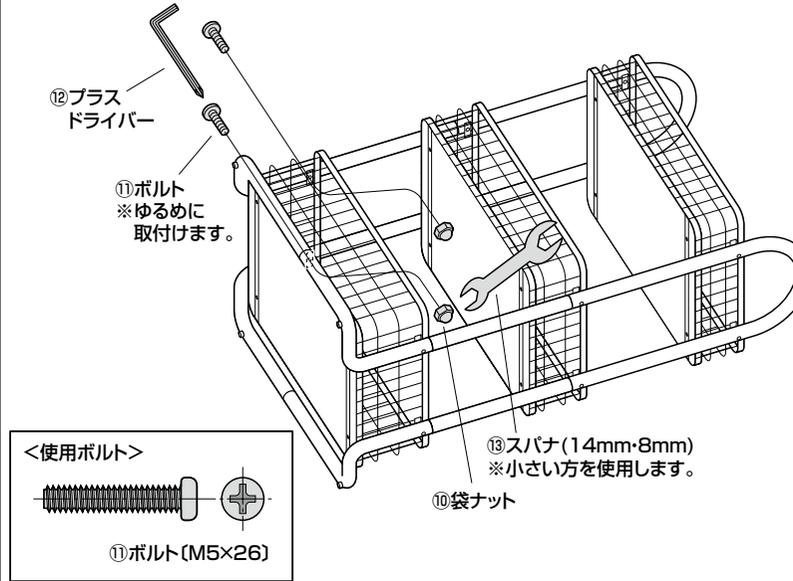
③フレームとカゴ(大)の反対側をボルトで固定します。
