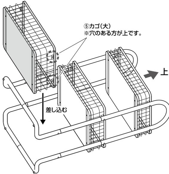
②フレームとカゴ(大)の片方をボルトで固定します。
