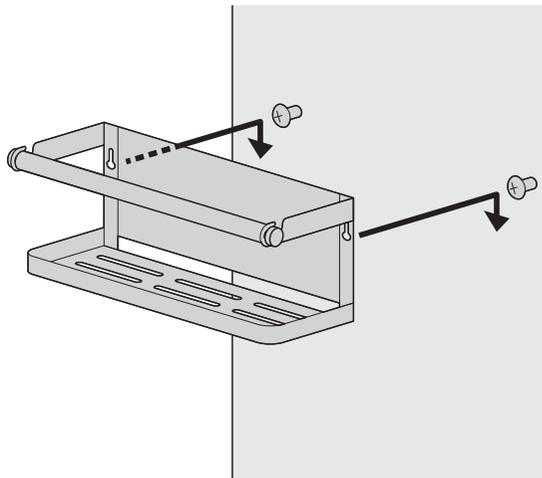
③タッピングねじを締め付けて固定します。
