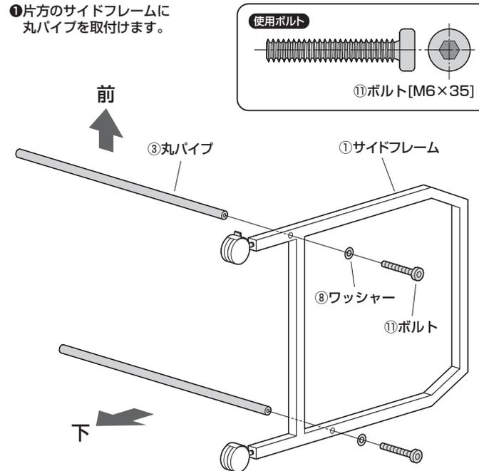
② もう片方のサイドフレームに丸パイプを取付けます。
