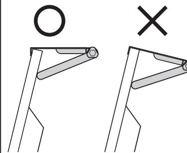
③ツマミをしっかり締め付けて固定します。
