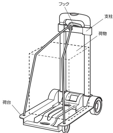
(3) 荷物に合わせてハンドルの長さを調節します。長さは3段階で固定されます。
