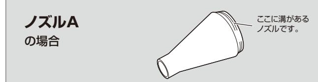
噴射口にノズルAを取り付けます。
