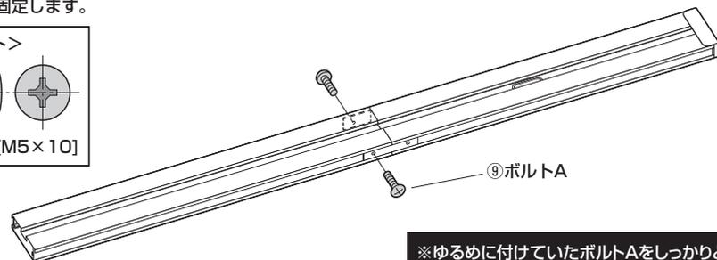
※ゆるめに付けていたボルトAをしっかりと締付けます。
