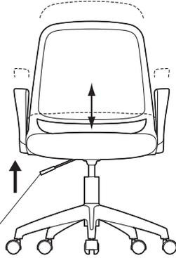
レバーを引き上げると座面の高さ調節ができます。
