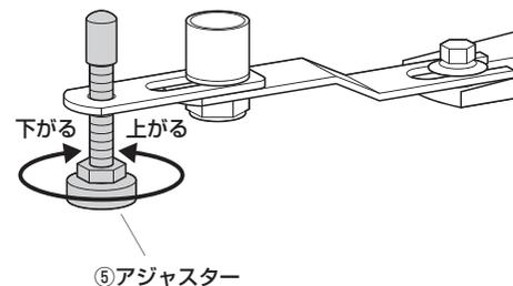
③ナットを矢印の方向に回して固定します。
