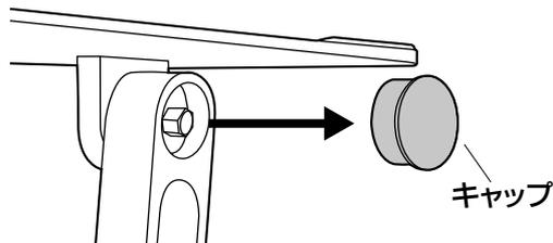
②ボックスレンチで固さを調節します。
