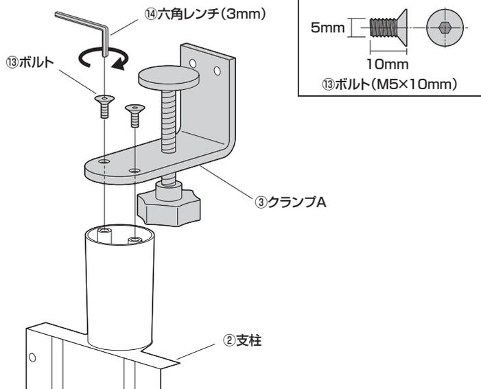
5.プレートに支柱を取付けます。
