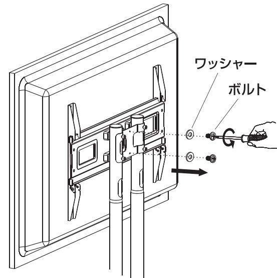
②取外したボルト、ワッシャーで上棚ブラケットを固定します。
