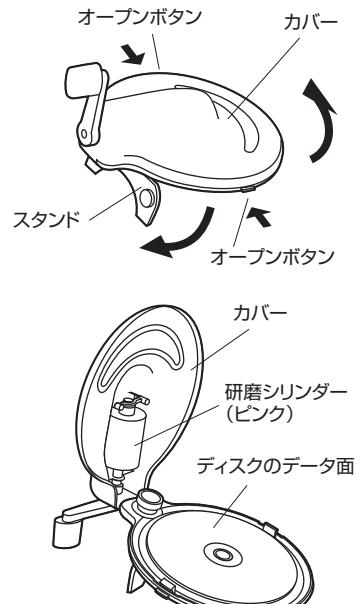
②研磨シリンダー(ピンク)をセットします。(シリンダーの交換方法参照)
