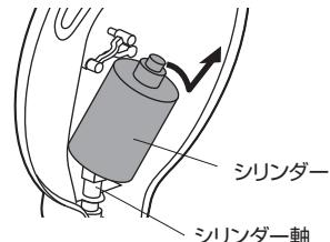
③交換するシリンダーの底面の角穴とシリンダー軸先端の四角い部分を合わせて取付けてください。
