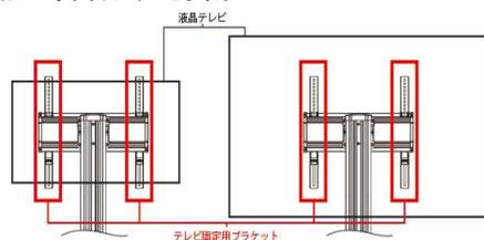
※2 取り付けは可能ですが、コネクターの一部が干渉する可能性があります。テレビ取り付け部品(ブラケット)を上下に設置調整する事でコネクタが接続
