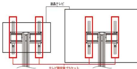
※2 取り付けは可能ですが、コネクターの一部が干渉する可能性があります。テレビ取り付け部品(ブラケット)を上下に設置調整する事でコネクターが接続可能です。
