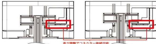
※3 取り付けは可能ですが、コネクターの一部が干渉する可能性があります。テレビ取り付け部品(ブラケット)を左右に設置調整する事でコネクターが接続可能です。
