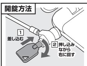
●鍵を錠の穴に合わせて差込み、 押し込みながら右回りに90°回転すれば開錠されます。
