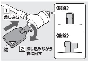
②鍵を錠の穴に合わせて差込み、押し込み ながら右回りに90°回転して、先端部分を 「開錠」にしてください。
