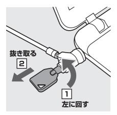
◆鍵を押し込みながら左回りに 90°回転して抜き取ると、本体 がスロットにロックされます。
